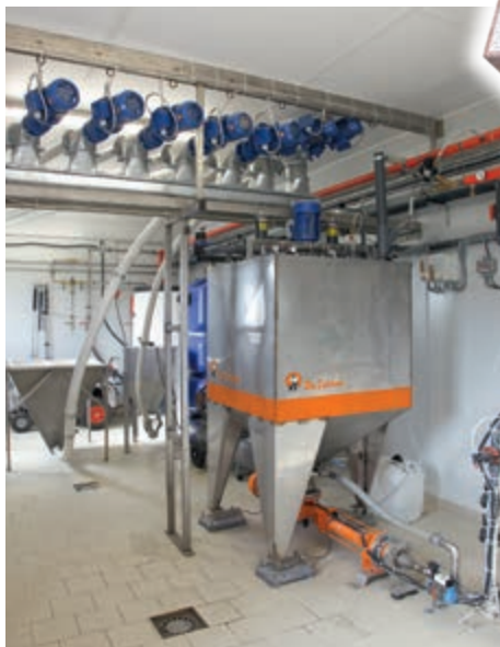
Hranidbena kuhinja: sistem sa 1 spremnikom (bez ostataka) sa zrakom pod tlakom
