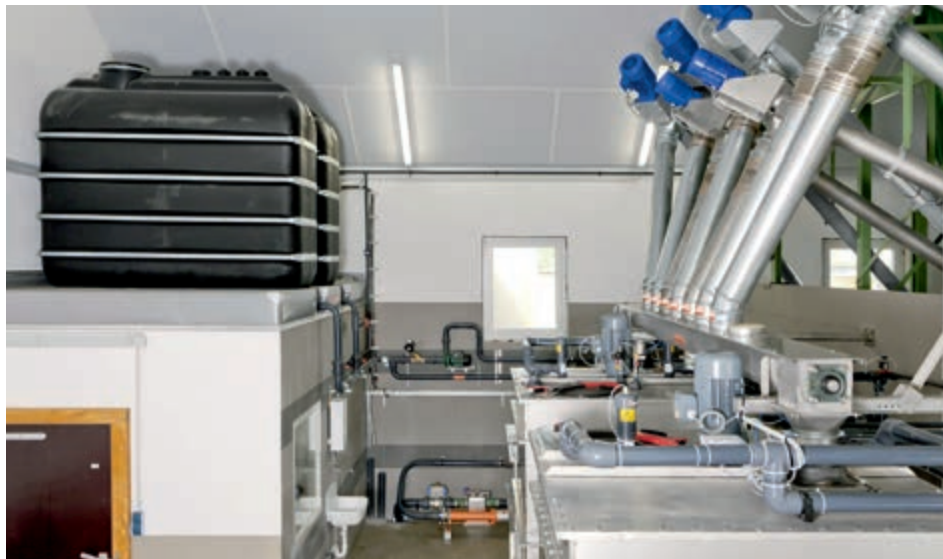
Hranidbena kuhinja sa 2 spremnika za hranjenje bez ostataka i sa dva spremnika za svježu vodu od 2000 L
